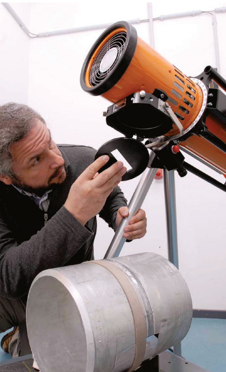
Vorbereitung einer Röntgenanlage für eine Aufnahme Preparation of X-ray equipment
