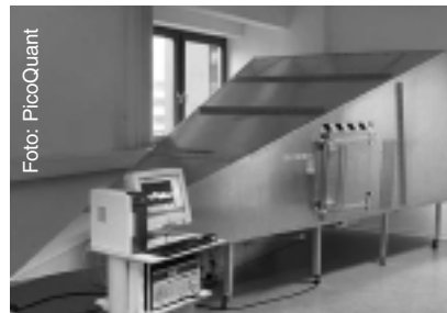
EMV-Messplatz mit GTEM 1000-Zelle
