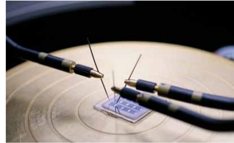
Messung einer Solarzelle im Labor
