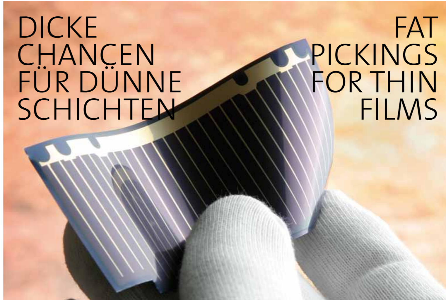
Dünne kristalline Silizium-Schichten sollen am Leibniz-Institut für Kristallzüchtung (IKZ) auf Glas aufwachsen
