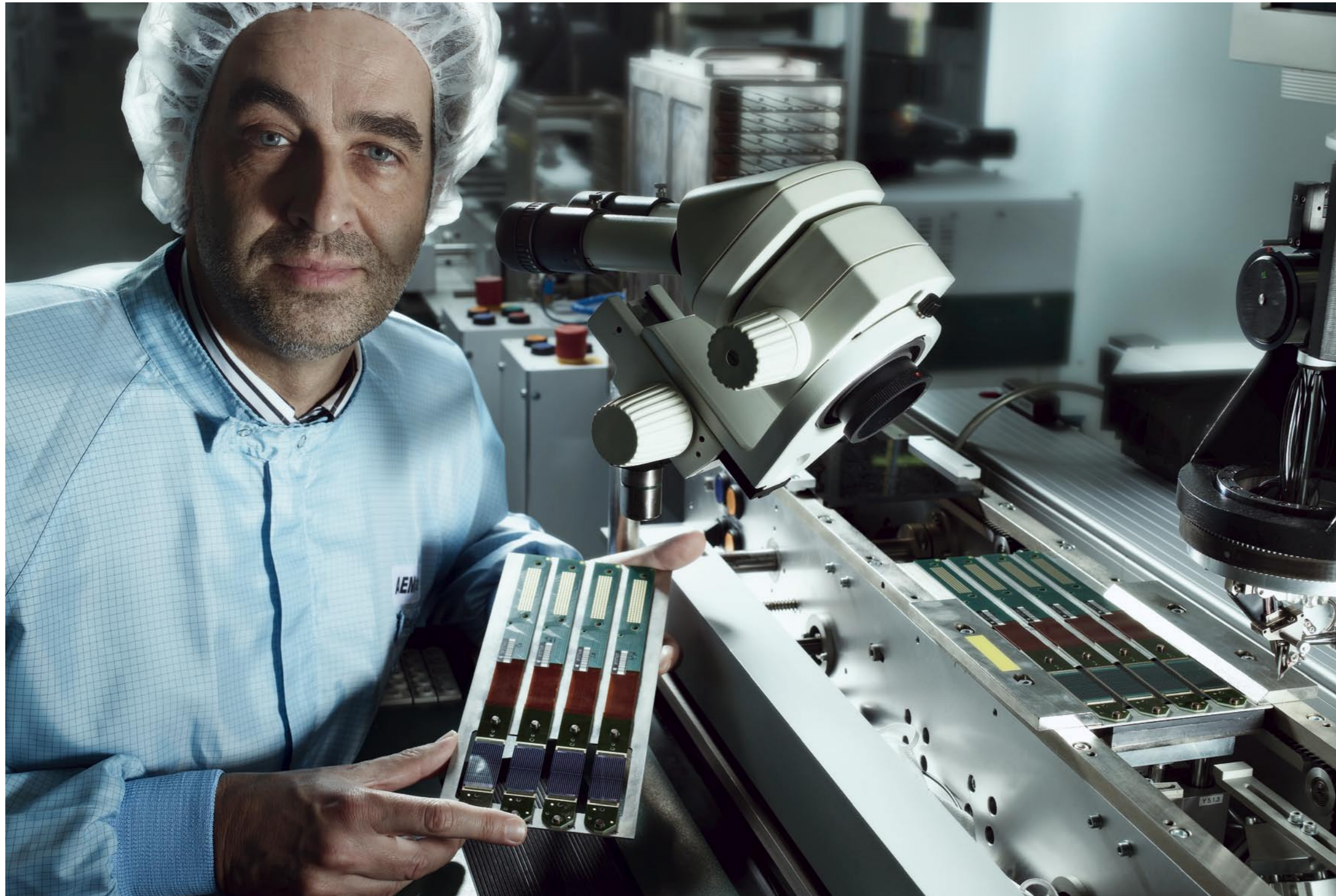
Am Prozessschritt „ Drahtbonden“ präsentiert Eckart Bredemeier, Prokurist der AEMTEC GMBH, Photodetektormodule, die mit über 1.000 Drahtverbindungen im Bereich der Medizintechnik Anwendung finden.
