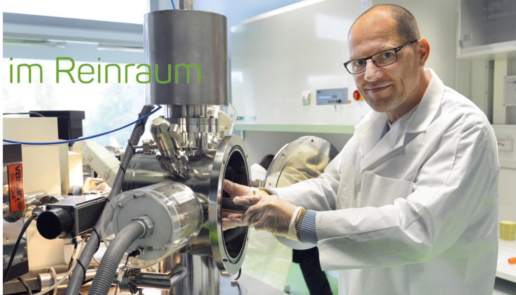
Jochen Vogl wechselt am Thermionen-Massenspektrometer das Probenkarussell
