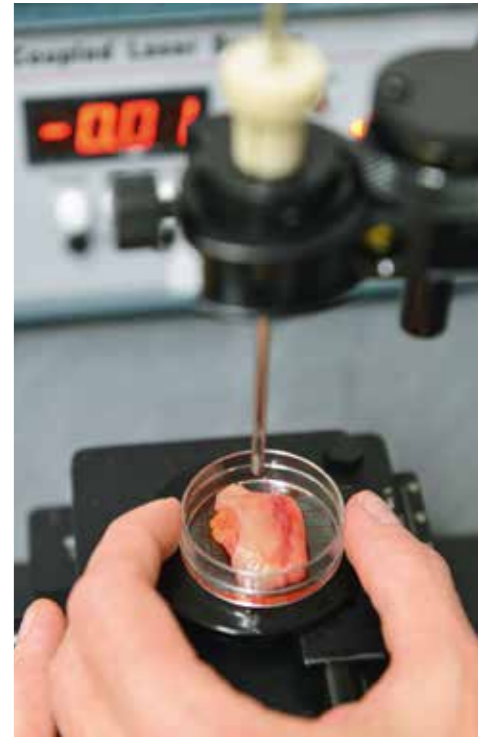
Gewebeprobe: Mit einer faseroptischen Sonde werden die Grenzen eines Tumors festgestellt. Die Messungen erfolgen für das Projekt FOMoS, das über den Europäischen Fond für regionale Entwicklung gefördert wird.
