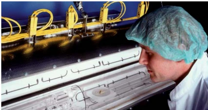
↑ Solarenergieforschung: Reaktionskammer zur Abscheidung von Solarzellenmaterial
