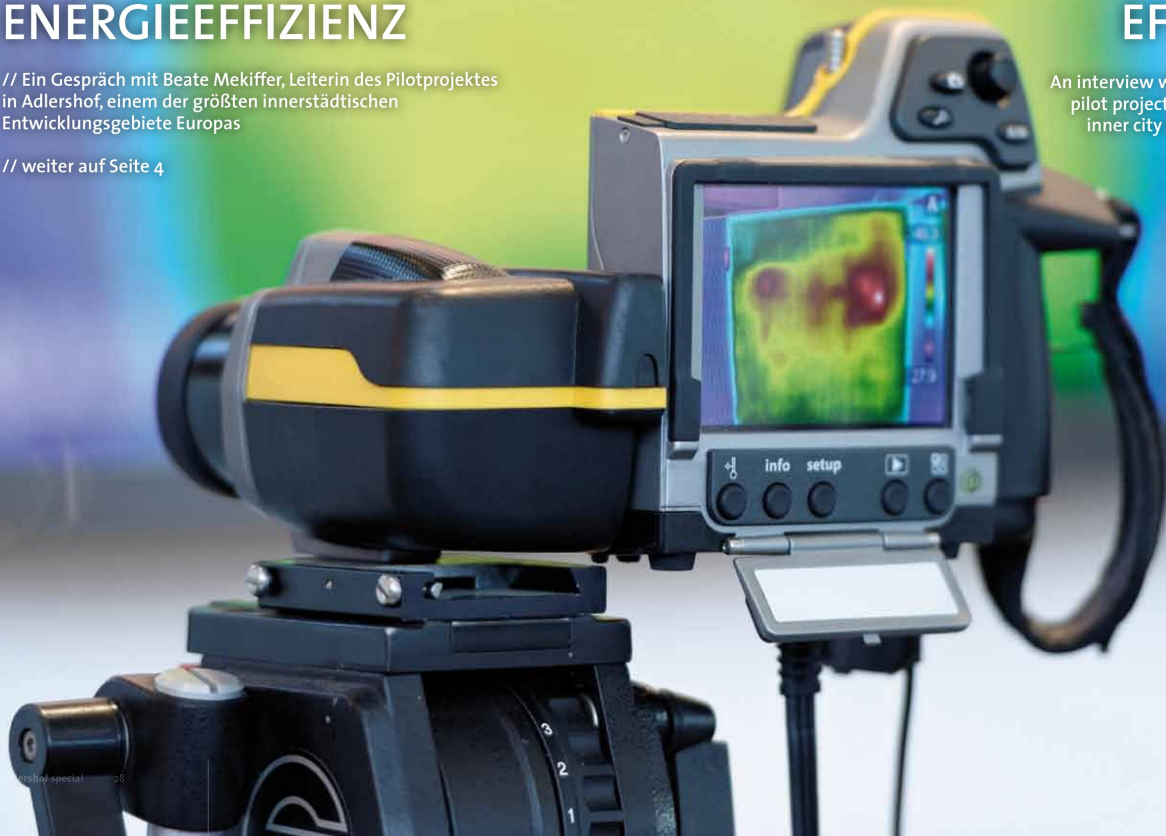
// Mit der Wärmebildkamera werden Wärmeverluste einer Fassade sichtbar gemacht
