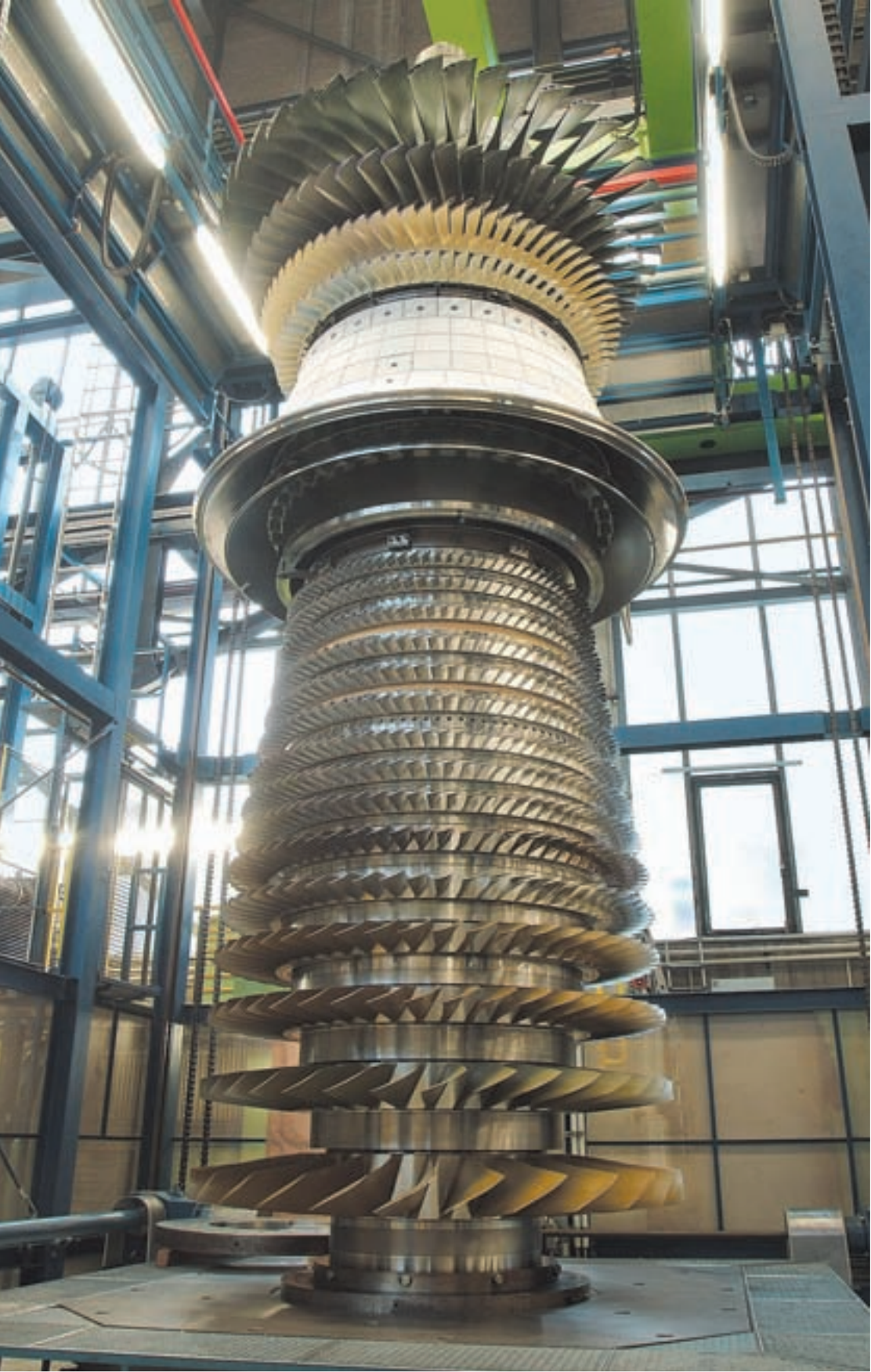
Im neuen Gasturbinenwerk von Siemens werden hauptsächlich Turbinenleitschaufeln bearbeitet. Eine Kraftwerksturbine besteht aus bis zu 10 000 Einzelteilen, davon etwa 3000 Schaufeln. Hier entstand auch die Rekordturbine
