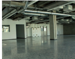
Reinraumproduktion (ISO 7-Klasse, ESD-Boden) / Clean-room production
