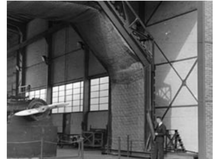
Der Luftschrauben-Schleuderprüfstand der DVL.
