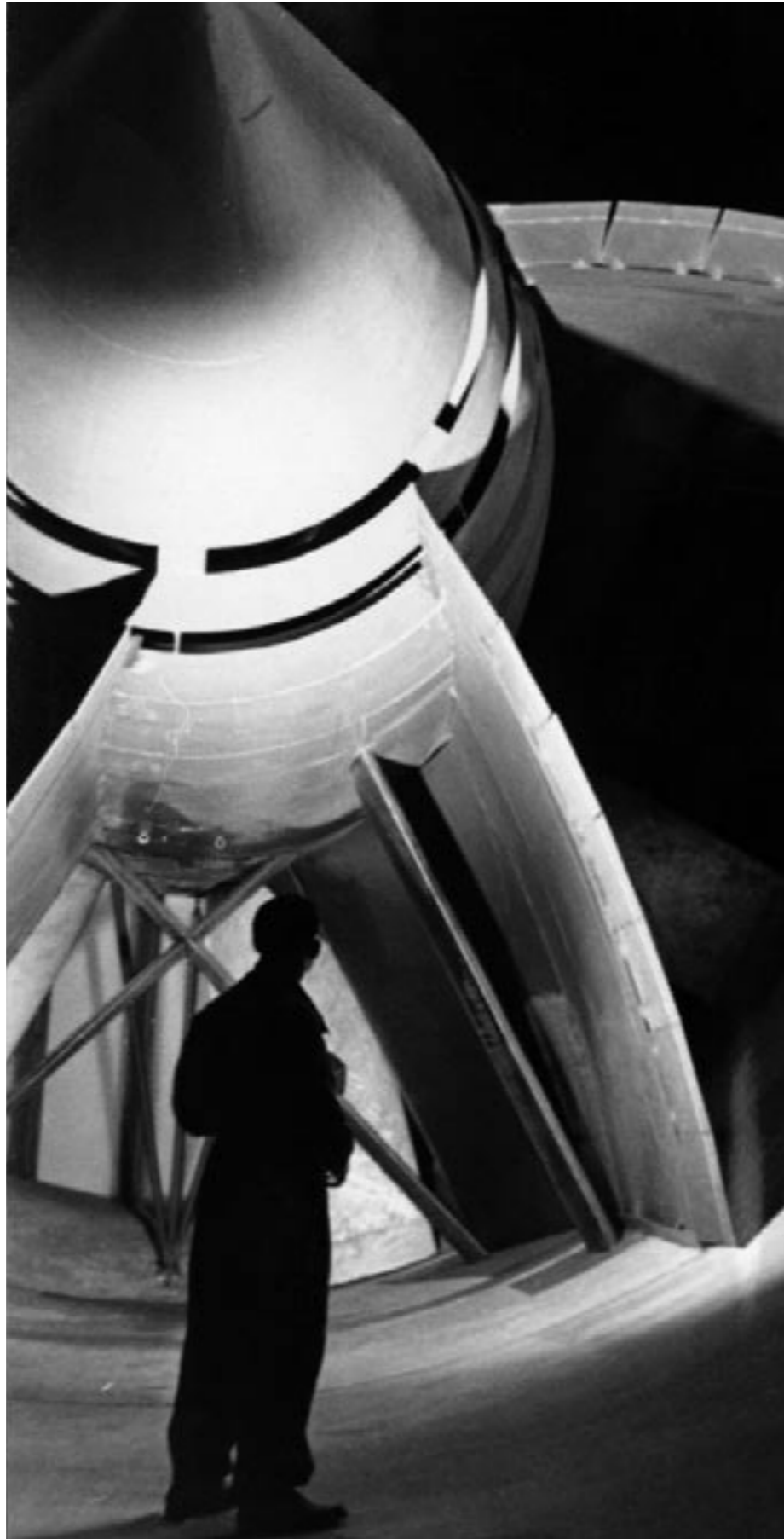
Antriebseinheit des „Großen Windkanals“, der Durchmesser beträgt 8,50 Meter. Der Antriebsmotor entwickelte 2.200 Kilowatt Leistung.
