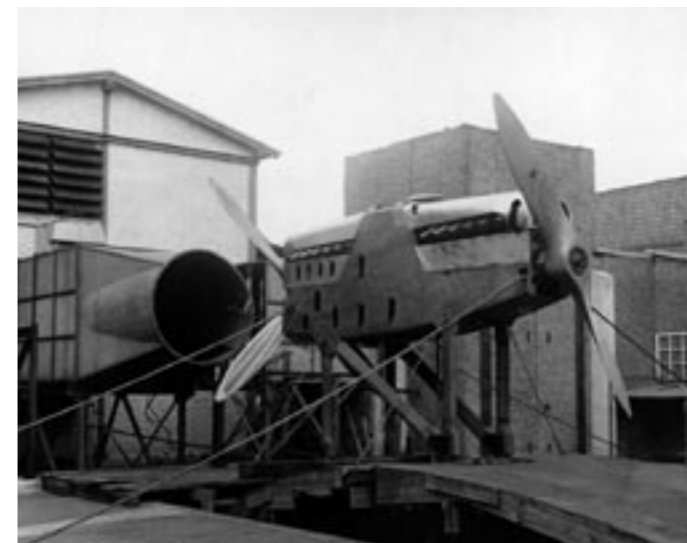
Tandem-Triebwerk eines Dornier-Flugbootes auf dem Motorenprüfstand.
