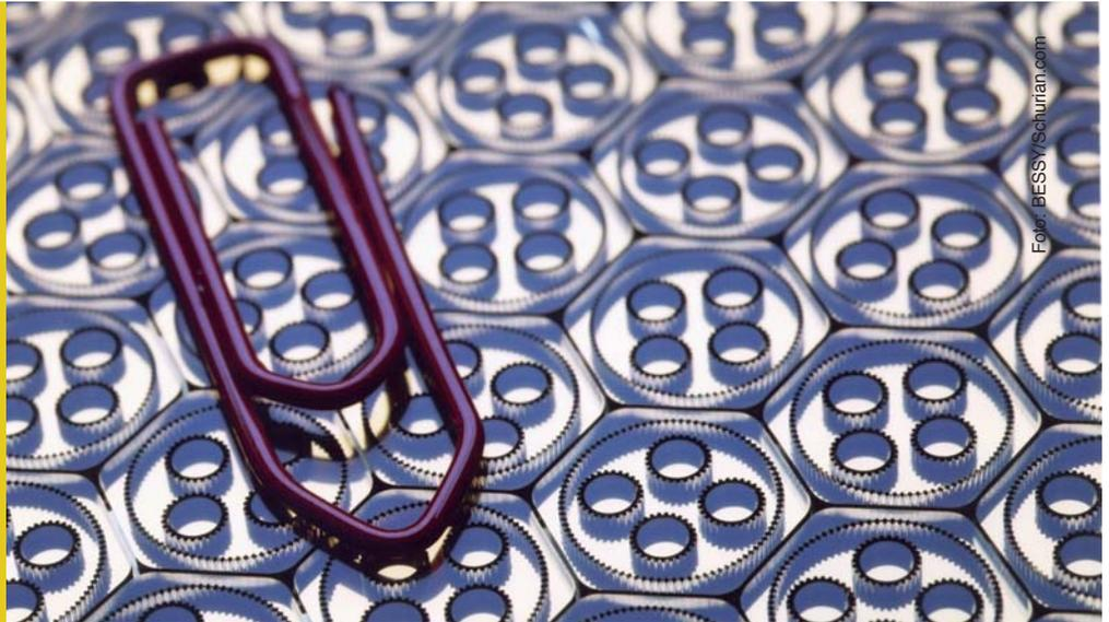
Röntgenlithographisch strukturierte Wafer mit Mikrotriebebauteilen
