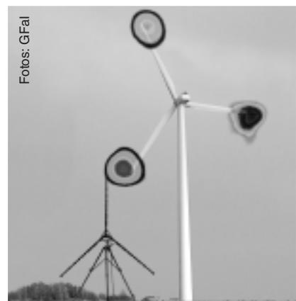
Lärm leistungsstärkerer Windkraftanlagen sichtbar gemacht
