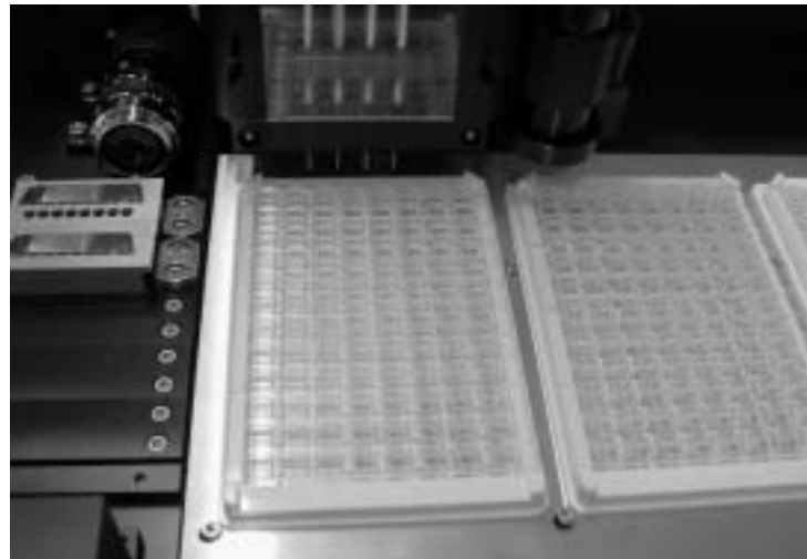
Der Sci FLEXARRAYER erlaubt das exakte Handling kleinster (100 Picoliter) Flüssigkeitsmengen.
