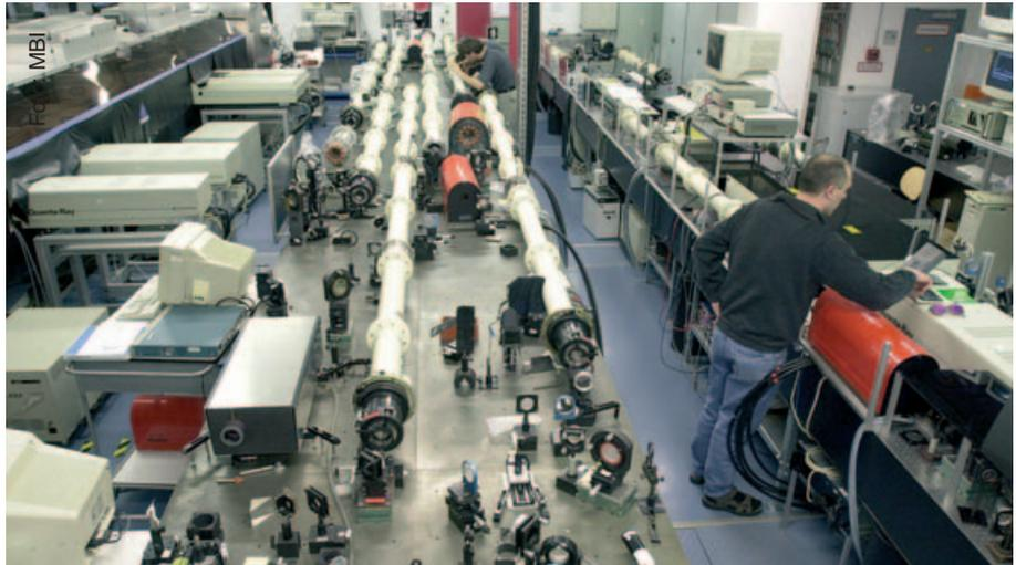
10 TW Glaslasersystem aus dem Höchstfeldlaser-Applikationslabor des MBI. Dieser Laser wurde bisher zum Entwickeln und Betreiben von Röntgenlasern genutzt. Die Arbeiten haben zu einer drastischen Verringerung der benötigten Pumpenergie für Röntgenlaser geführt, so dass nun auch kleinere Pumplaser eingesetzt werden können.
