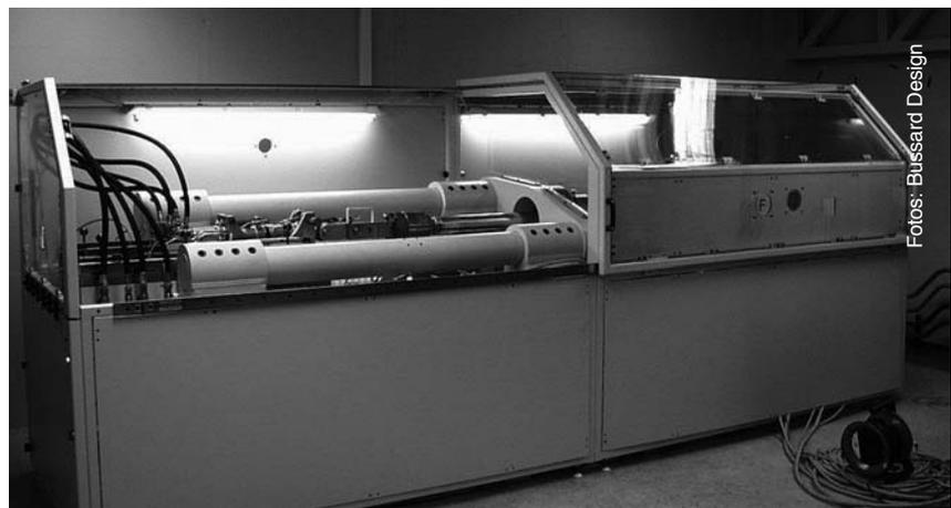
Der von Bussard Design entwickelte Hydraulikprüfstand für den Eurofighter
