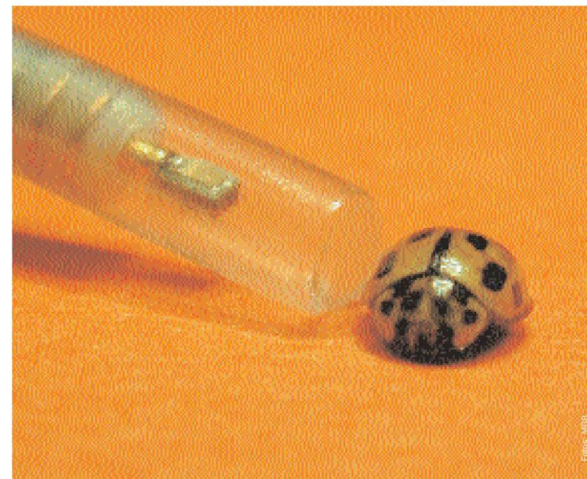
► Mikromotor-getriebene Ultraschallsonde in Käfergröße
