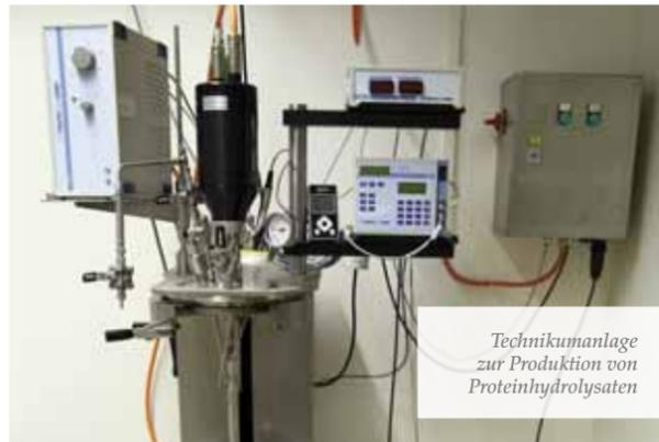
Technikanlage zur Produktion von Proteinhydrolysaten
