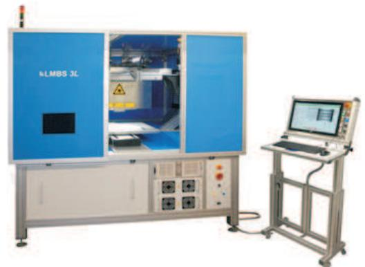
LMBS 3L Laserbearbeitungsanlage mit 3 Lasern
