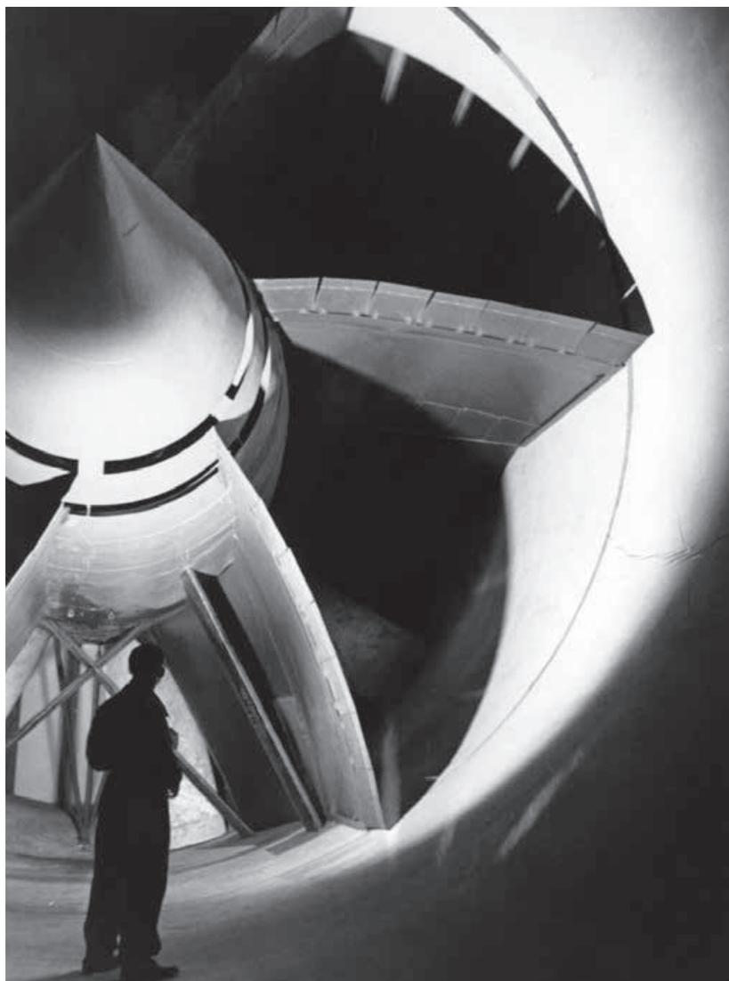
Antriebseinheit des „Großen Windkanals“, der Durchmesser beträgt 8,50 Meter. Der Antriebsmotor entwickelte 2.200 Kilowatt Leistung
