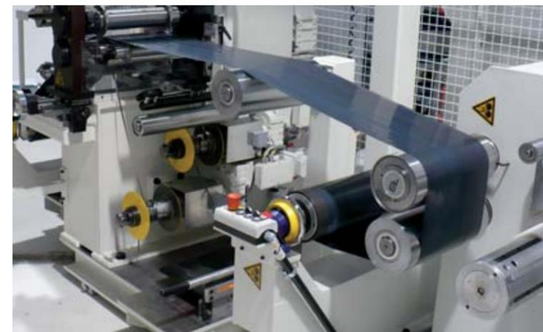
↑ Dünnschicht-Solarzellen-Produktion: Auf einer Edelstahlfolie werden in mehreren Prozessschritten unterschiedliche Schichten aufgebracht
