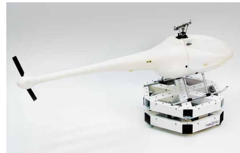
Resonic-Messung Schwerpunkt Koordinaten: Messung von Masseeigenschaften einer Drone
