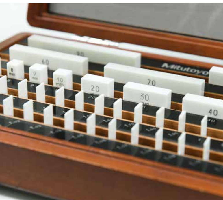
Endmaßkasten zur Einstellung oder Prüfung von Messgeräten
