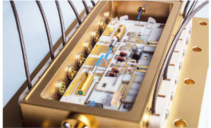
Mikrointegrierter Diodenlaser – MOPA – MasterOszillator-Leistungsverstärker – für die präzise Iodspektroskopie im Weltraum.
