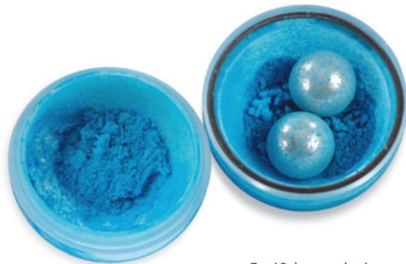
Zwei Pulver wurden im „Überraschungsei“ von Stahlkugeln zu einem Produkt gemahlen
