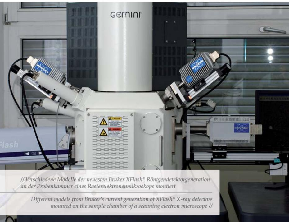
// Verschiedene Modelle der neuesten Bruker XFlash® Röntgendetektorgeneration an der Probenkammer eines Rasterelektronenmikroskops montiert
