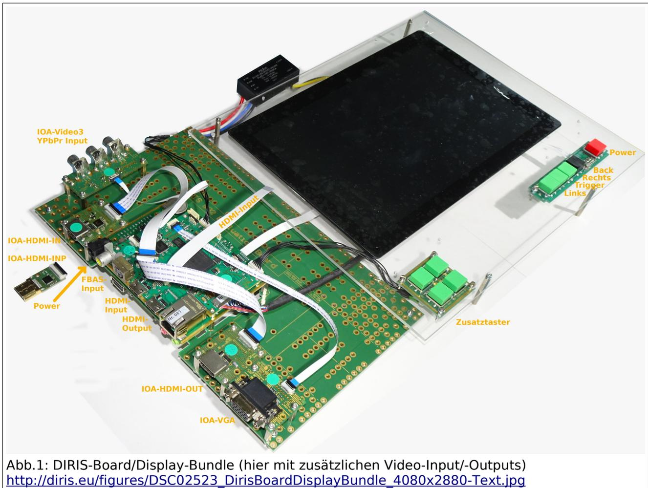
Abb.1: DIRIS-Board/Display-Bundle (hier mit zusätzlichen Video-Input/-Outputs)
