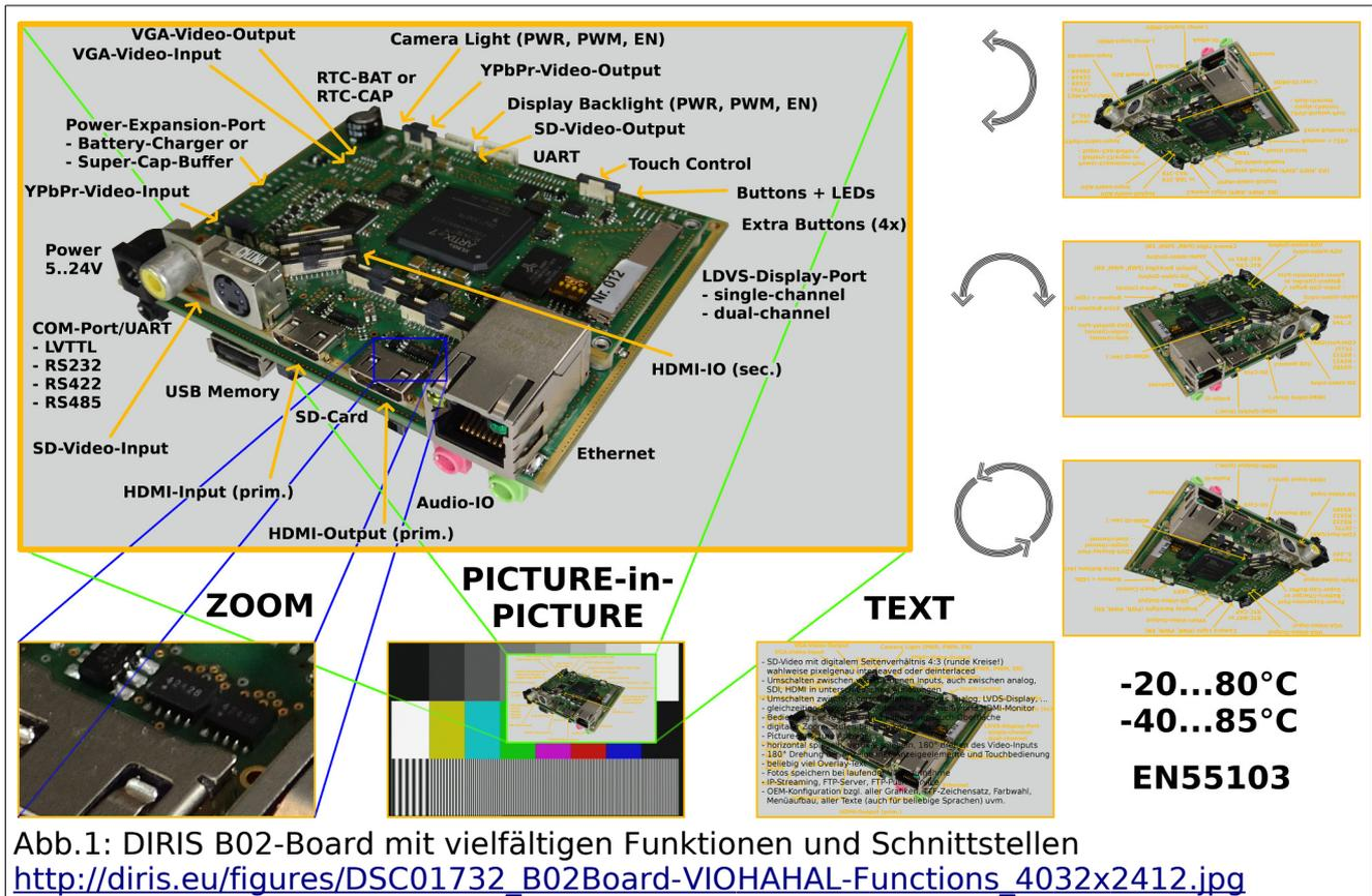
Abb.1: DIRIS B02-Board mit vielfältigen Funktionen und Schnittstellen
